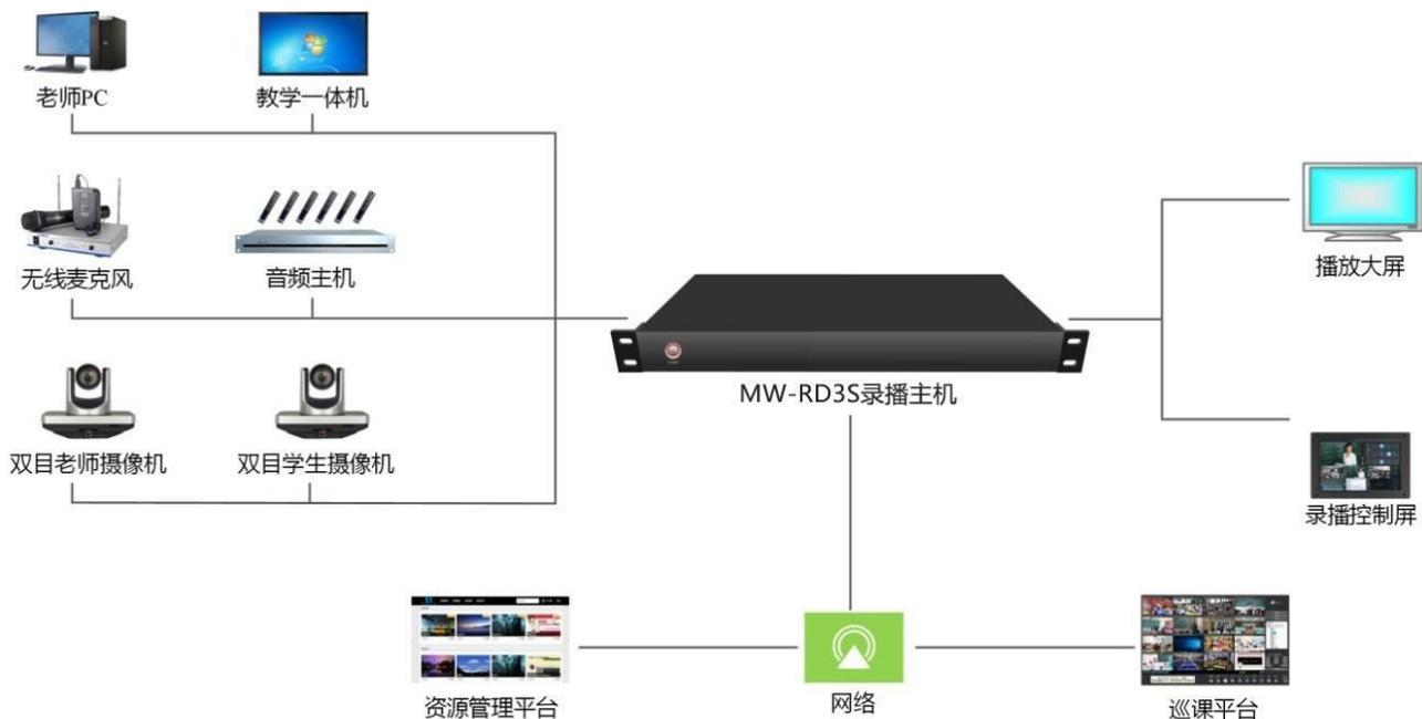
MW-RD3S 是一款集课件录制、直播、点播、智能导播、存储等多功能于一体的集成录播设备，基于嵌入式硬件架构设计，产品高度稳定。设备支持 5 场景（老师全景、老师特写、学生全景、学生特写、电脑信号）的音视频采集录制，配合跟踪系统实现全自动跟踪导播。设备支持电影模式+资源模式同时录制和直播，画面支持 1/2/3/4/6 分屏、画中画模式显示和录制。录播主机 MW-RD3S 搭配弦子广电录播触控屏，让用户的操作更灵活、快捷。结合资源管理平台、导播巡课平台可实现各种不同场景的应用需求。
