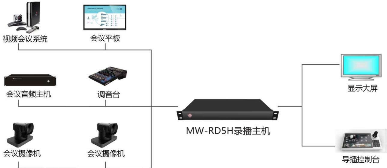
MW-RD5H 是一款集课件录制、直播、点播、智能导播、存储等多功能于一体的集成录播设备，基于嵌入式硬件架构设计，产品高度稳定。设备采用 H.264 编码，具有 5 路 HDMI 视频输入接口，支持 1080P@60fps 图像输入。共有 2 路视频输出接口，多路画面输出满足在播放系统上显示图像并且可以作为其它系统的图像输入源（如视频会议系统）。系统支持电影模式+资源模式并存的同步录制和直播，画面支持画中画、1/2/3/4/6 分屏模式显示和录制。用户既能在本地接上鼠标、显示器和导播台进行导录播操作，也可以在 PC 上登录 IE 进行远程导播。
