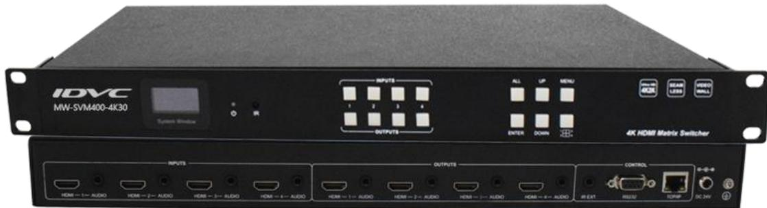
MW-SVM400-4K30 是一款 HDMI 4K 无缝拼矩可连接 4 路 HDMI 信号源到 4 个显示器和 4 路 HDMI 输出，高输入输出分辨率支持 4K30 任意 Scaler 输出。输入支持模拟音频加嵌，输出支持音频解嵌和分离。拼接支持 4K 输入输出与边框补充功能。前面板支持按键操作和 OLED 屏状态反馈与操作提示。采用 B/S 架构 WEB GUI 人机交互界面，PC 端无需安装软件即可控制设备。支持通过 GUI 升级设备固件维护和升级提供便利；设备操控除 GUI 和按键控制，还支持 RS232 串口/TCP/IP 网口指令控制以及 IR 红外遥控器控制。外观采用 1U 尺寸大小材质用铝壳设计。
